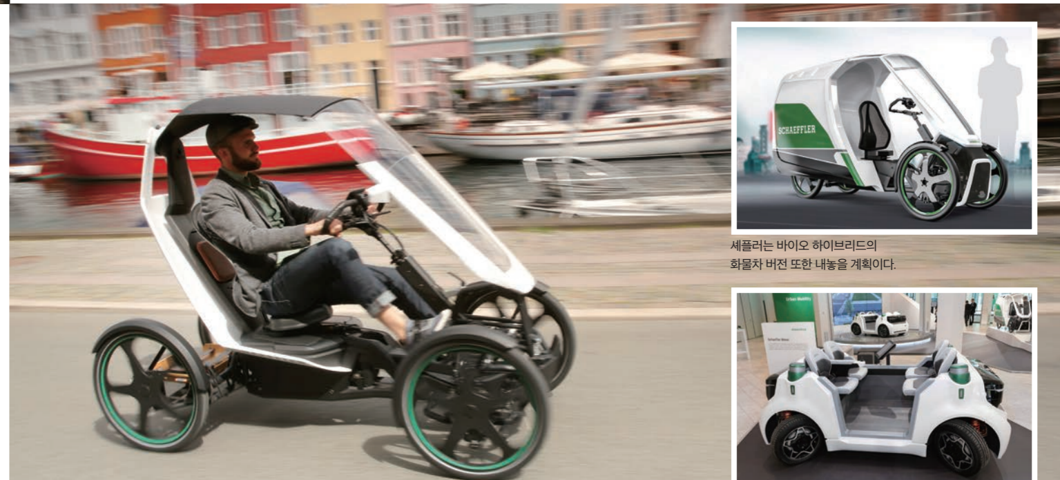
세플러 무버: 전기휠 허브 구동, 90도 회전과 모듈식 디자인 덕분에 이 콤팩트한 플랫폼은 도시지역에서 다양한 이동식 솔루션으로 유연하게 이용될 수 있으며 자유롭게 확장 축소 가능하다.
