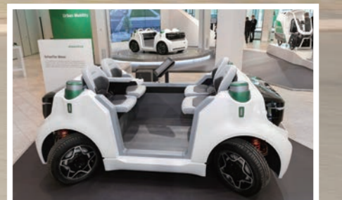
세플러 무버: 전기휠 허브 구동, 90도 회전과 모듈식 디자인 덕분에 이 콤팩트한 플랫폼은 도시지역에서 다양한 이동식 솔루션으로 유연하게 이용될 수 있으며 자유롭게 확장 축소 가능하다.
